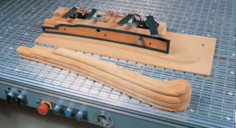
Aposite scanalature a "T" rovesciata e fori filettati offrono un'ancoraggio ideale per tutte le attrezzature di bloccaggio.
