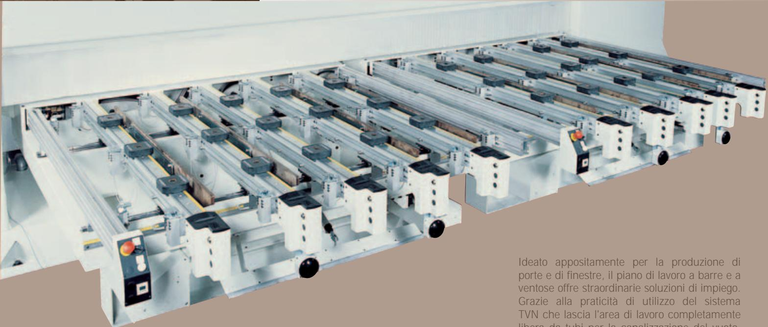
Il piano TVN permette di aggiungere tutte le ventose necessarie per il bloccaggio specifico del pezzo e di passare da ventose a morsetti con semplici gesti, senza l'impiego di chiavi o altri strumenti di bloccaggio.
