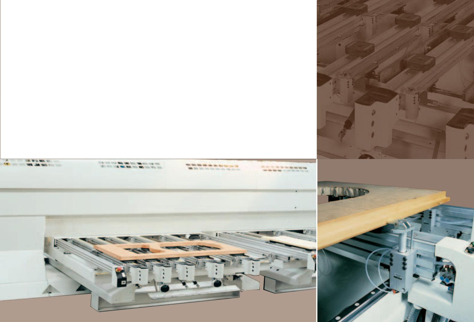
Ventose studiate sulle dimensioni dei montanti tipici delle porte, battute di riferimento per pezzi impiallacciati, riferimenti centrali ed un'intera gamma di soluzioni specifiche per risolvere le problematiche di chi produce porte.
